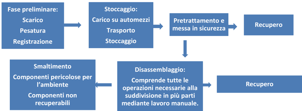
Figura 1. - Schema a blocchi di un impianto di smaltimento di apparecchiature elettriche ed elettroniche.
